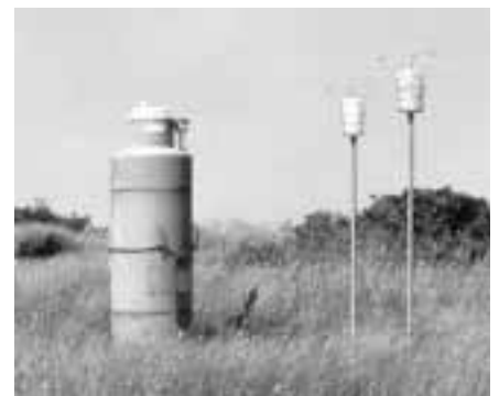
▶ Abbildung 2: Wet-Only-Sammler vom Typ ARS 721 am Messpunkt St. Peter-Ording.
