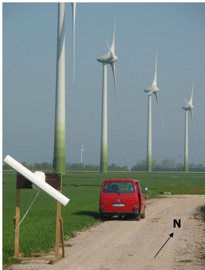
Abb. 10: Aufbau des vertikal ausgerichteten Radargerätes quer zur Hauptzugrichtung im Frühjahr am Untersuchungspunkt 2 am Ostrand des Windparks (siehe Abb. 8).
