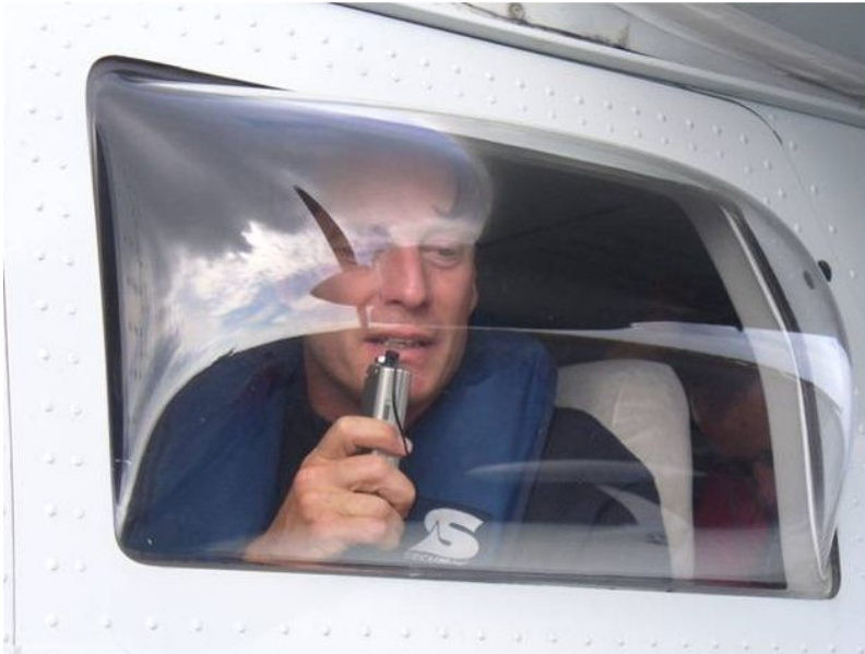
Abb. 3.2 Beobachtungssituation mit gewölbten Fenstern ("bubble-window").
