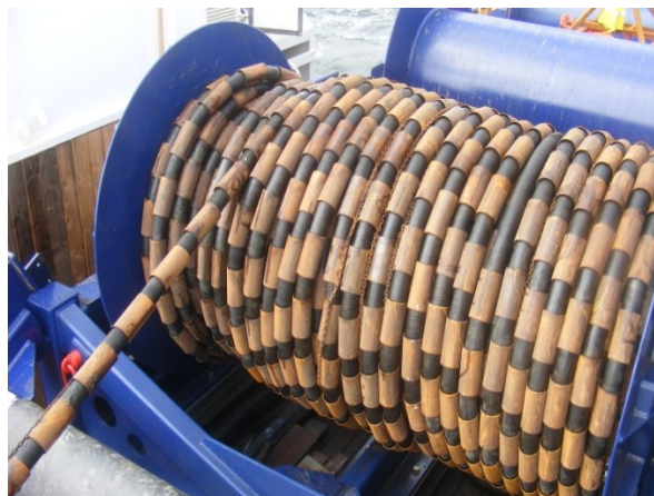
Abb. 1-14: Düsen Schlauch ummantelt mit Stahlmanschette und Kette auf einer Winde an Bord der Noortruck.
