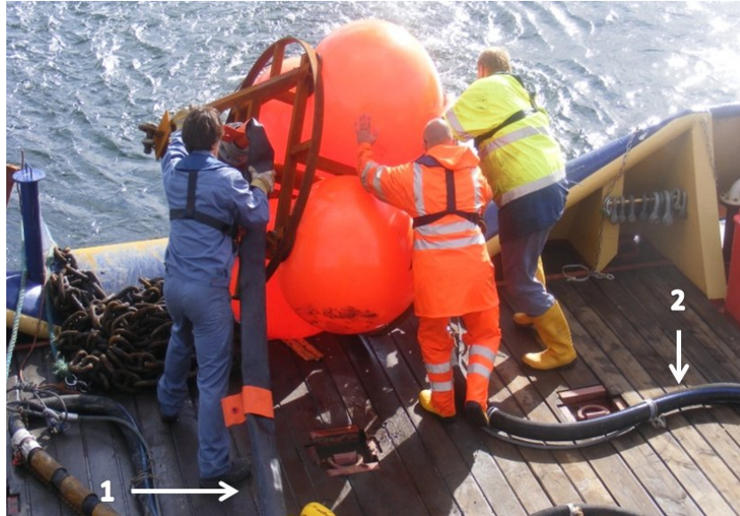
Abb. 1-13: Rechts neben dem Seemann im blauen Arbeitsanzug ist ein Luftversorgungsschlauch (1) zu sehen. Das Ende des Luftversorgungsschlaches ist mit einer Markierungsboje versehen. Auch der Düsen Schlauch ist auf dem Bild erkennbar (2).
