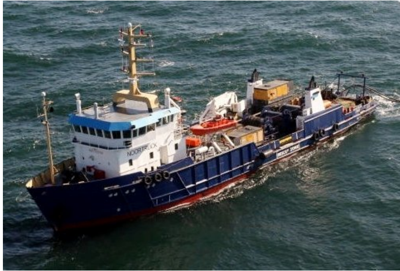
Abb. 1-9: Das Blasenschleier-Versorgungsschiff Noortruck.
