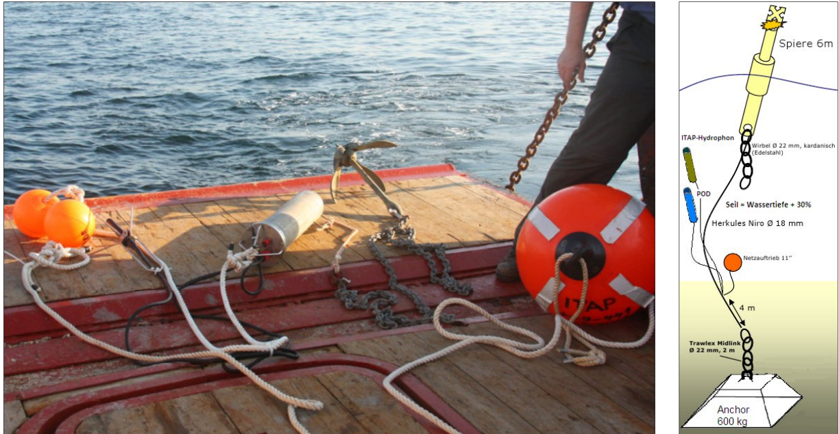
Abb. 1-24: Links: Autonomes Hydroschallmessgerät inkl. eigener Verankerung. Von links nach rechts: Auftriebskörper für Hydrophon, Hydrophon mit Schutzkorb, Gehäuse mit Messelektronik (liegt beim Einsatz am Meeresboden), zusätzlicher Anker, Markierungsboje. Rechts: Verankerung der C-PODs und der Hydroschallmessgeräte. Beim Einsatz an C-POD-Stationen entfällt die eigene Verankerung an den Hydroschallmessgeräten.
