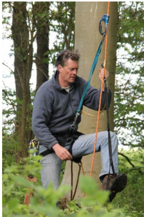
Abb. 3 Seilklettertechnik mit semistatischem Kern-Mantelseil 11 mm mit (linker) gelber Fuß- und (rechter) blauer Bruststeigklemme (Thomas Grünkorn, Foto Projektgruppe Seeadlerschutz).
