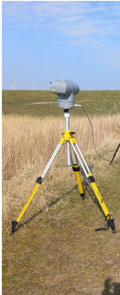
Abbildung 7: Beispielbild eines mobilen AVES Wind Onshore AKS System (Bild ProTecBird 2023).
