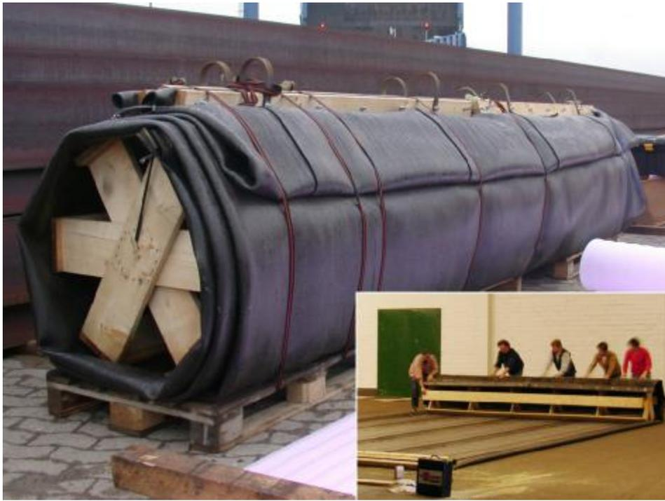
Bild 4.11. Schallschutzvorhang auf Transportrolle
