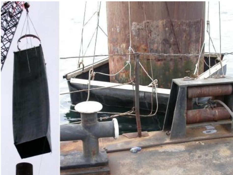
Bild 4.12. Schallschutzvorhang am Kran und in Messposition
