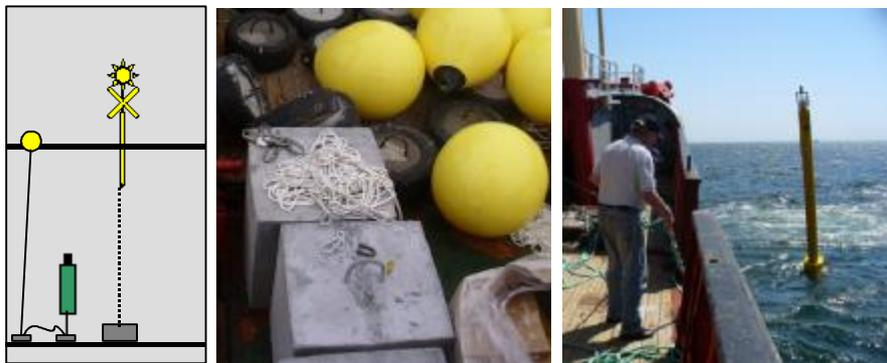
Abb. 5: Schematische Zeichnung der Leuchtspiere mit POD-Verankerungssystem und Fotos des Bojenankers und der Spiere auf See.
