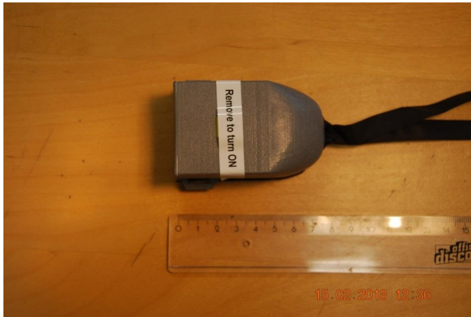
Abb. 1 GPS/GSM-Batteriesender mit Teflonbändern für die Befestigung als Rucksack. Die rechte Seite des Senders zeigt in die Flugrichtung des Vogels.
