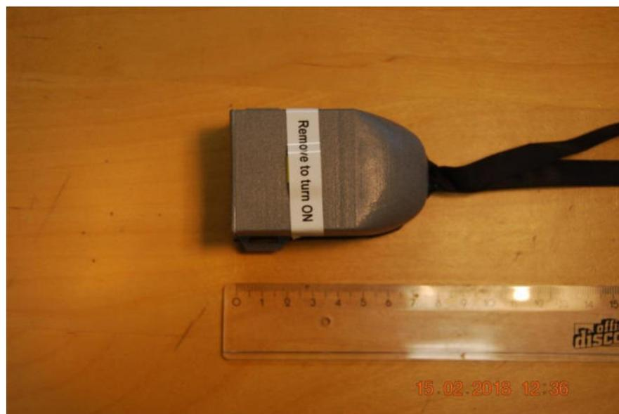
Abb. 6 GPS/GSM-Batteriesender der Fa. Ornitela ([www.ornitela.com](http://www.ornitela.com)) mit Teflonbändern für die Befestigung als Rucksack.
