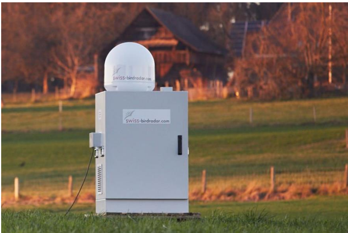
Abbildung 36: Vogelerfassungsradar MR1 der Firma Swiss Birdradar Solution.
