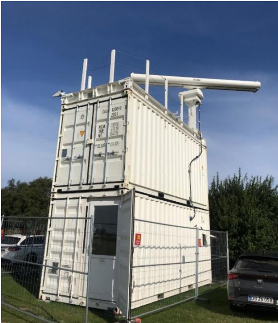
Abbildung 39: Testaufbau des BNK-Radars (Terma Scanner 4002) in der Nähe von Putgarten auf Rügen.
