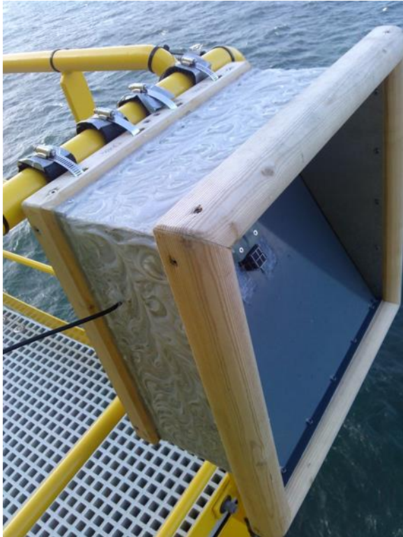
Abbildung 38: Offshore-Mikrofonsystem der Firma BioConsult SH.
