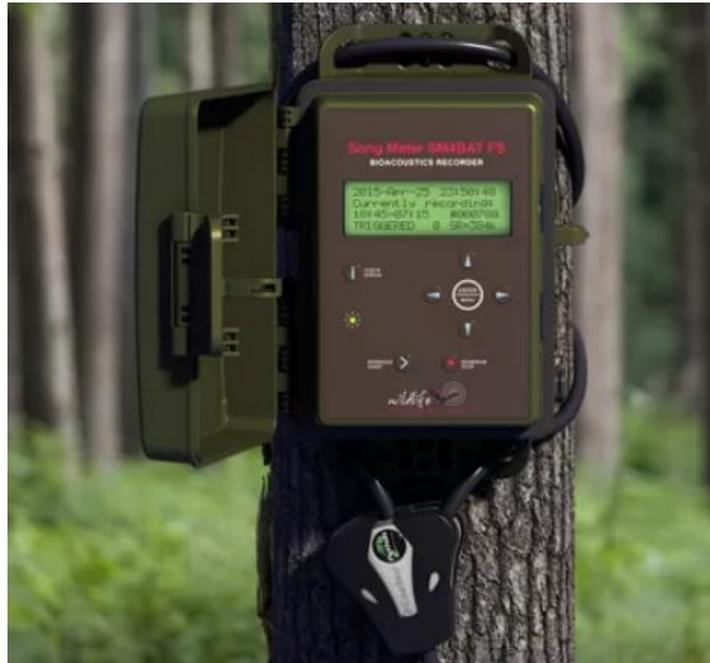
Abb. 2-9 Eingesetzte Fledermaushorchbox vom Typ SM4Bat Wildlife Acoustics (<https://www.wildlifeacoustics.com/products/song-meter-sm4bat>).
